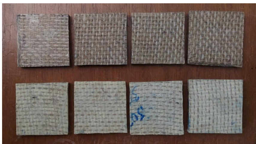
Figura 25 - Corpos de prova dos compósitos reforçados com fibra de juta, com filler de partículas de vidro, na fileira de cima, e de nanopartículas de titânio (esbranquiçado), na fileira de baixo, para os testes de absorção.
