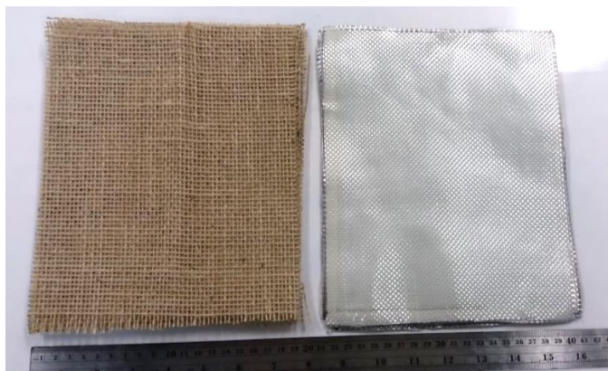
Figura 13 - Mantas de fibra de juta e de fibra de vidro cortadas em retângulos
