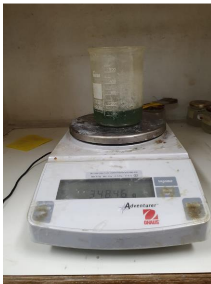
Figura 21 - Medição da proporção de resina e endurecedor em balança eletrônica
