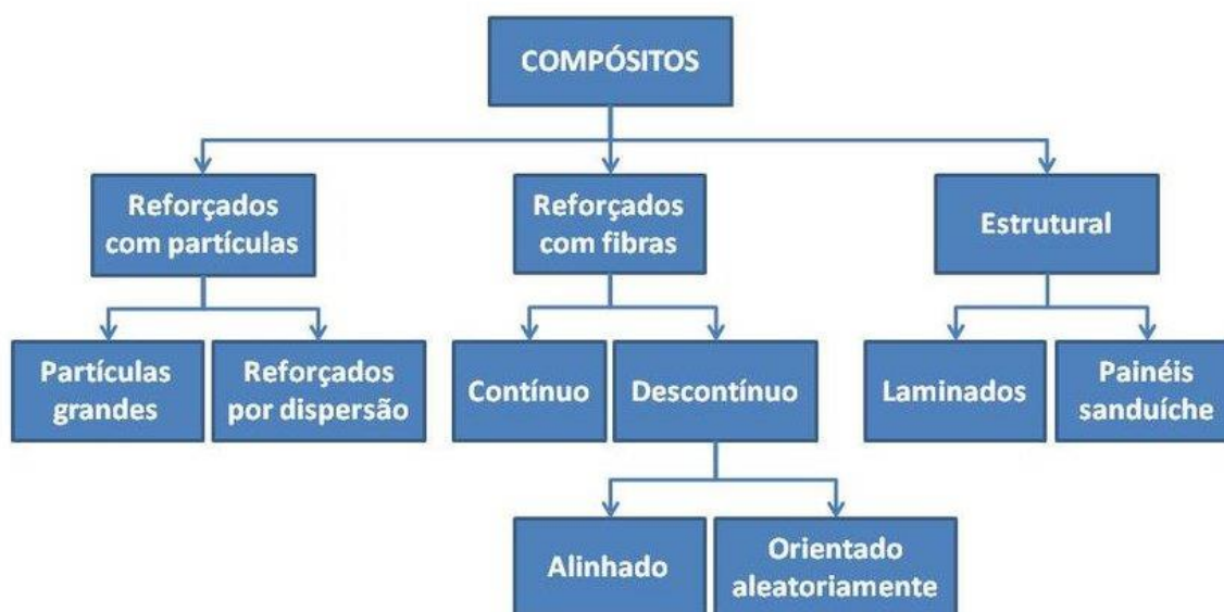
Diagrama 2 - Classificação dos compósitos quanto ao tipo e disposição de reforço Fonte: (ALVES; OTANI; MELO; AMICO, 2014)
