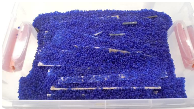
Figura 26 - Corpos de prova inseridos em recipiente com sílica gel
