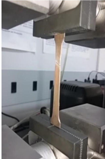
FIGURA 23: Fratura a 45° com deformação lateral no corpo de prova a 0° da DL.
