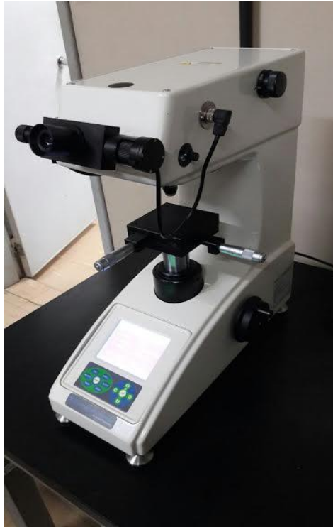
FIGURA 8: Micro durômetro AnInstron Company do Laboratório de Materiais, CEFET/RJ.
