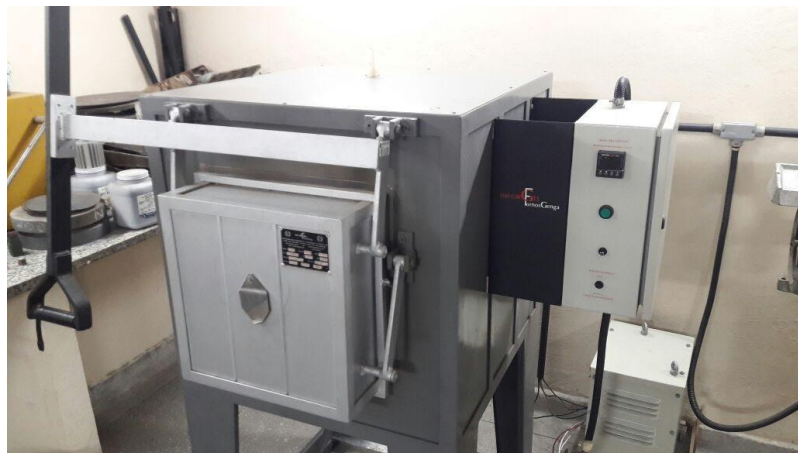
FIGURA 6: Forno de recozimento do Laboratório de Metalografia e Tratamentos Térmicos, CEFET/RJ
