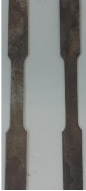
FIGURA 12: Corpos de prova usinados no Laboratório de Pesquisa e Usinagem, CEFET/RJ.
