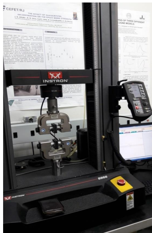
FIGURA 10: Máquina universal para ensaios mecânicos Instron- Modelo 5966, Laboratório de Compósitos e Adesivos, CEFET/RJ.
