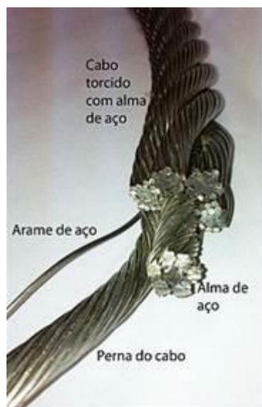
**Figura 29:** Seção transversal do cabo de aço
