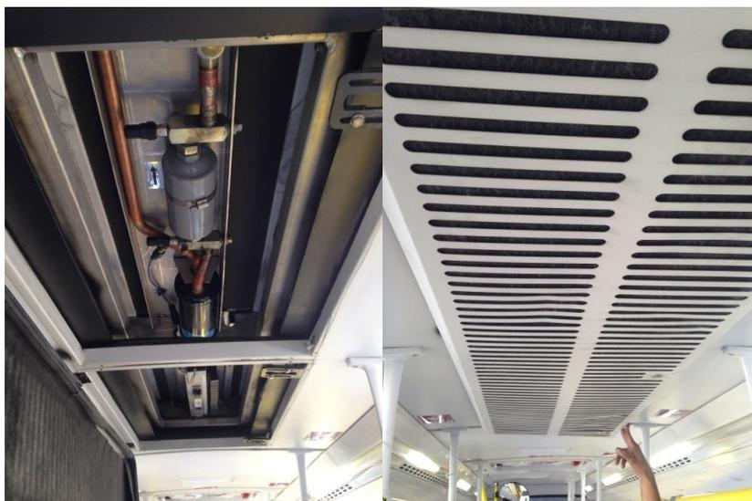
Foto – Sistema de refrigeração com a grade proteção de abeta e fechada.
