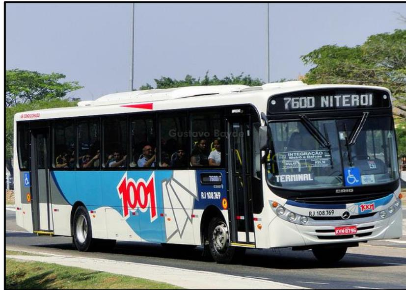
**Figura 18:** ônibus 1001 em operação. Carroceria Apache Vip III e Chassis Mercedes-Benz
