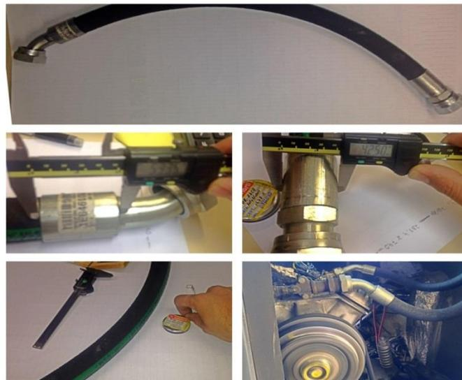
**Figura 49:** Mangote sendo medido e inspecionado, para elaboração do modelo 3D.
