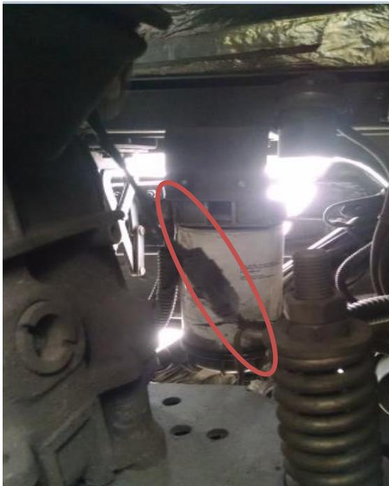
**Figura 46:** Chicote Elétrico do Compressor do Ar Condicionado
