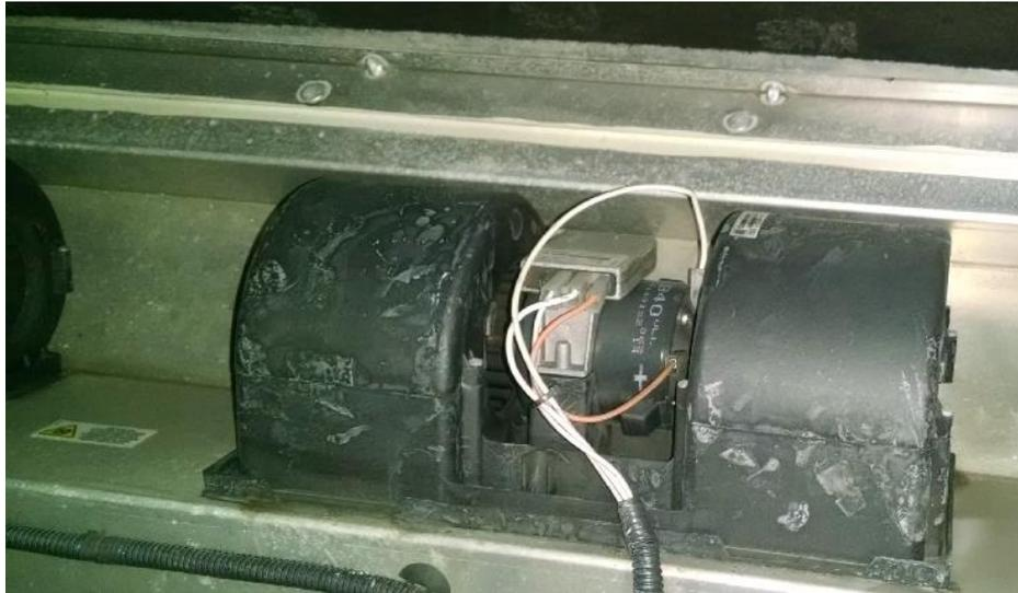
**Figura 72:** Motor do Evaporador – Modelo SPALL B40
