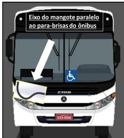
**Figura 53:** Localização e orientação do mangote em relação ao ônibus
