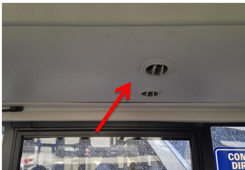
Foto – Dispositivo de saída do ar refrigerado indicado.
