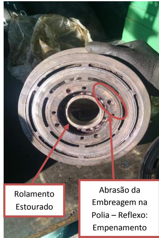
**Figura 63:** Polia do Compressor Do Ar Condicionado.
