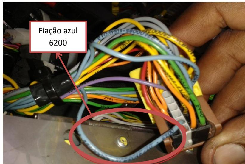
**Figura 68:** Alterações da Fiação de Alimentação do Alternador-Fiação
