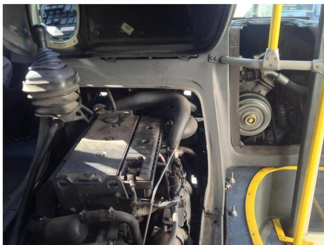
Foto – Motor com a tampa de proteção aberta e direita a porta de entrada do passageiro.
