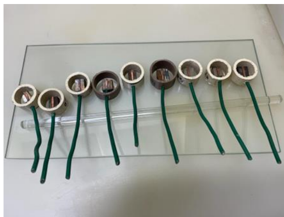
Figura 32 – Amostras em etapa intermediária de preparação para o ensaio de corrosão. Fonte: AUTORES, 2022.
