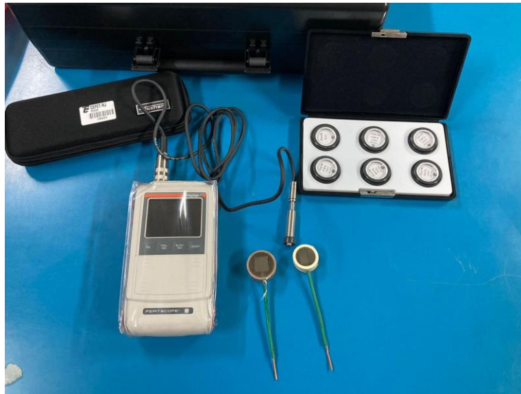
Figura 29 – Ferritoscópio FMP30 da marca FERITSCOPE. Fonte: AUTORES, 2022.
