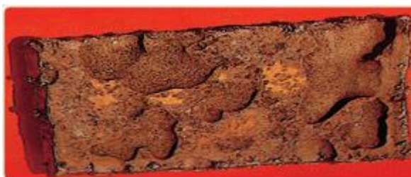
Figura 8 – Corrosão por placas em uma chapa de aço-carbono. Fonte: KRELLING, 2021.
