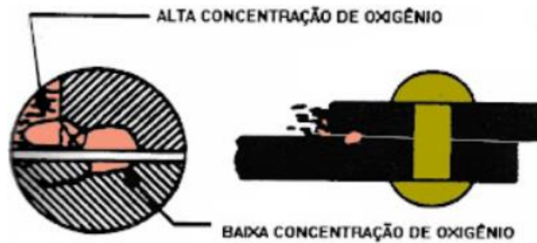
Figura 9 – Princípio esquemático de aeração diferencial. Fonte: Mecânico das Aeronaves.
