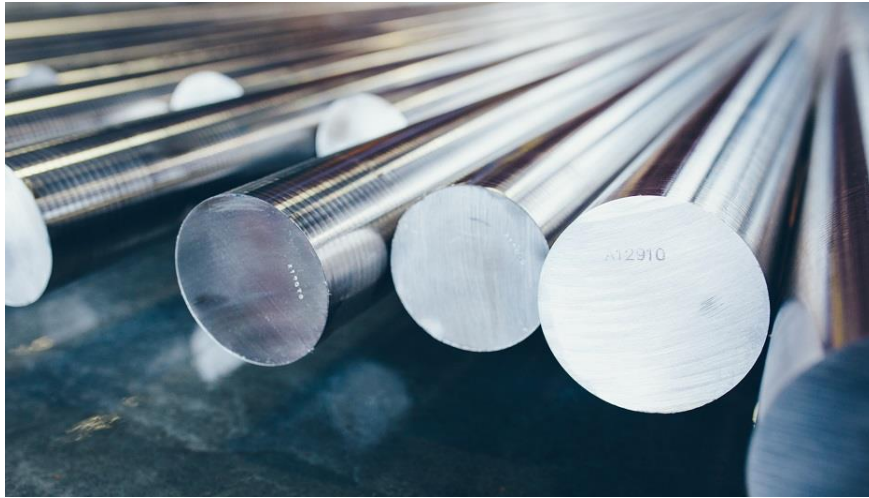
Figura 17 – Acabamento superficial de peça laminada. Fonte: Aços Nobres.
