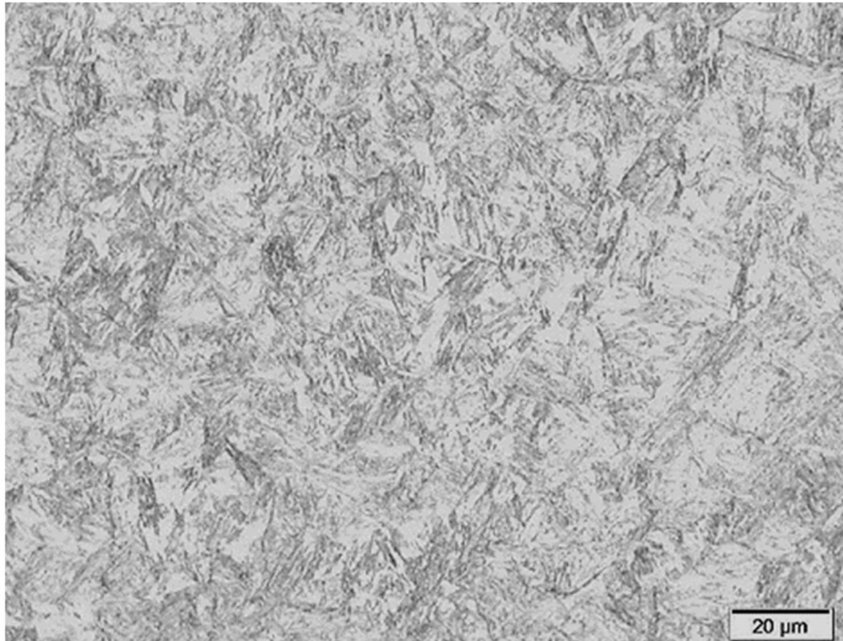
Figura 16 : Imagem obtida por microscopia óptica da amostra T. Microestrutura composta por martensita revenida. Ataque com nital. Aumento de 1000X.
