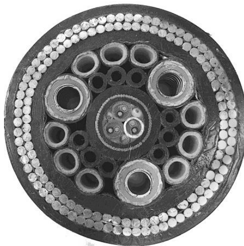
Figura 2 – Seção de um Umbilical Eletro-hidráulico [12]
